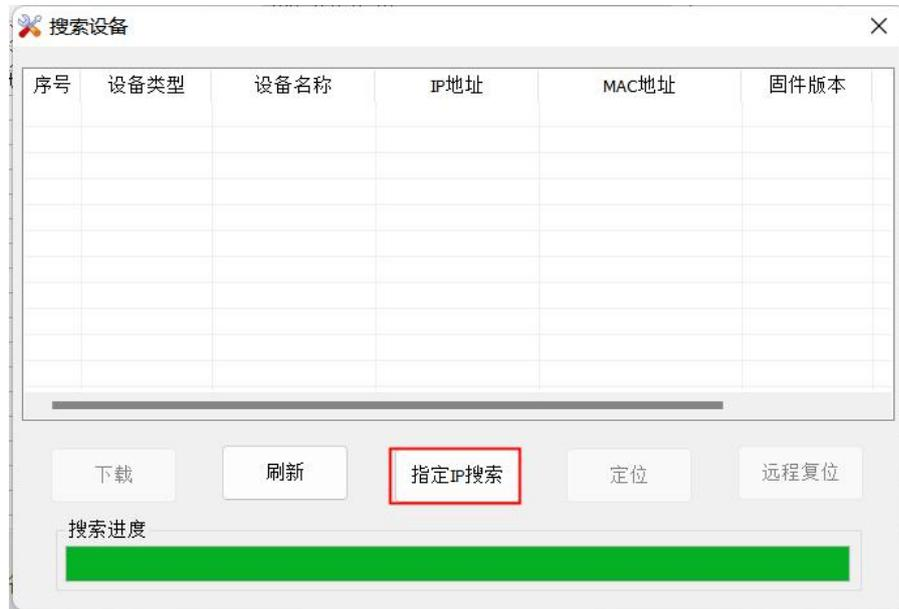
输入正确 IP 地址后，软件会搜索网络中具有这个 IP 地址的 BMT-370 设备。
