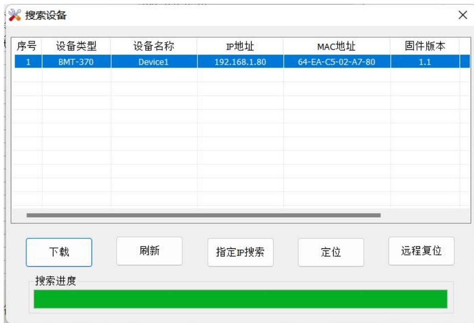
点击“下载”，显示下载成功，点击确定后，网关自动重启，下载的配置信息生效。
