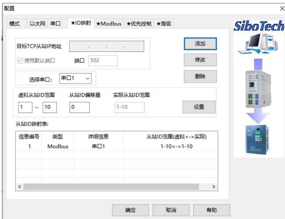
当用户选择“RTU/ASCII 主站模式”时，需要设置“目标 TCP 从站 IP 地址”，即要连接的服务器的 IP 地址。
