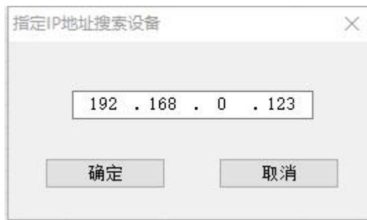
输入正确的 IP 地址后，软件会搜索网络中具有这个 IP 的 ENB-301MT 设备，并把该设备的信息显示在主界面的列表中。
