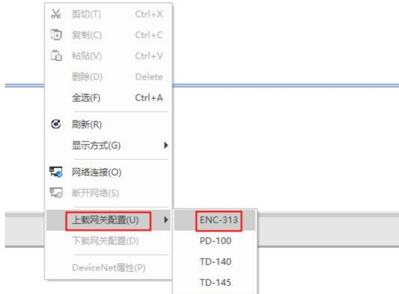
上载完成后主窗口中显示上载的设备并提示上载成功，双击上传的主站设备可以查看和修改配置信息，从站的节点信息可以在主站的扫描列表中查看和修改，也可以修改网关 Modbus TCP 端的 IP 地址，如下图所示
