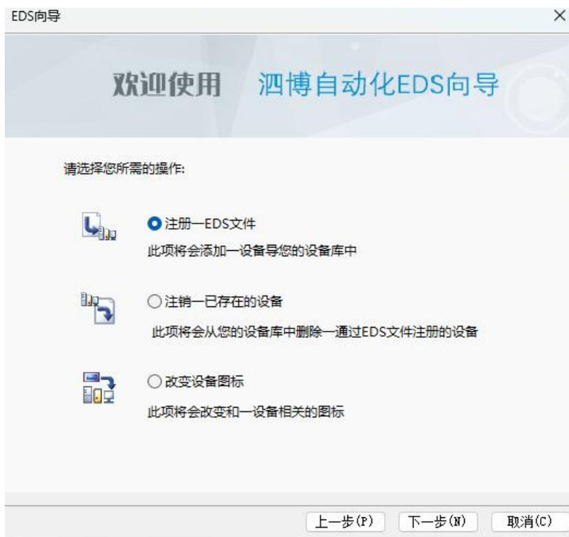
在此界面，用户可以进行注册—EDS 文件、注销—已存在的设备、改变设备图标操作。
