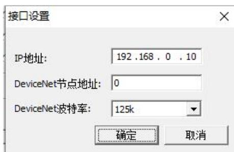
注意接口设置配置，“IP 地址”为搜索时选中的设备 IP，“DeviceNet 节点地址”为 DeviceNet 主站模块的地址，设置 0~63 之间的任意值，不能与总线上其它节点地址冲突，“DeviceNet 波特率”为 DeviceNet 主站模块的波特率，125K、250K、500K 可选，保持总线波特率一致。
