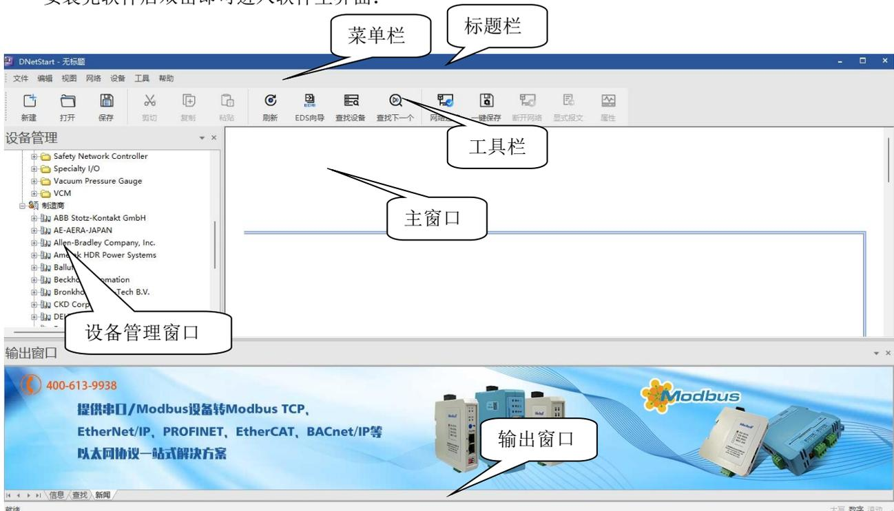
主窗口：建立网络连接后，显示在线设备，并能在线修改设备地址、参数等，查看输入输出数据；在离线状态下，通过将设备图标拖到这个窗口，可查看设备属性。
