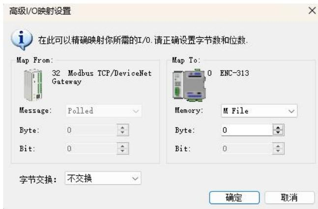
若需设置“高级 I/O 映射设置”中映射起始地址的单位，可点击“选项”按钮设置。如下图所示，“Byte Align”表示以一个字节为单位，“Word Align”表示以两个字节为单位：
