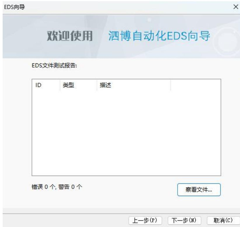
点击“下一步”，弹出 EDS 文件测试报告界面，如果 EDS 文件有错误，则不能进行“下一步”，没有错误，继续“下一步”，弹出选择设备图标界面：
