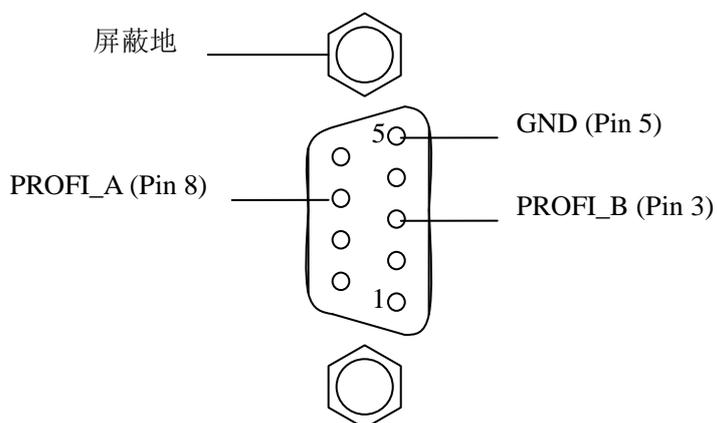
PROFIBUS DP 接口采用 DB9 孔型接头，其引脚定义如下：
