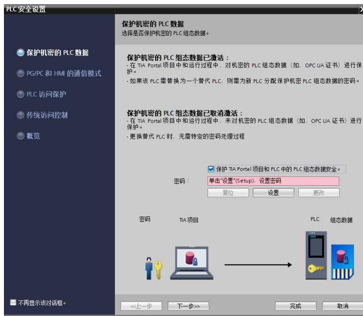
图 3 修改 PLC 安全设置
