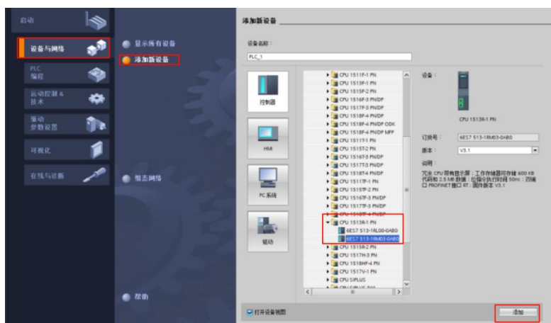
图 2 添加 CPU 型号
