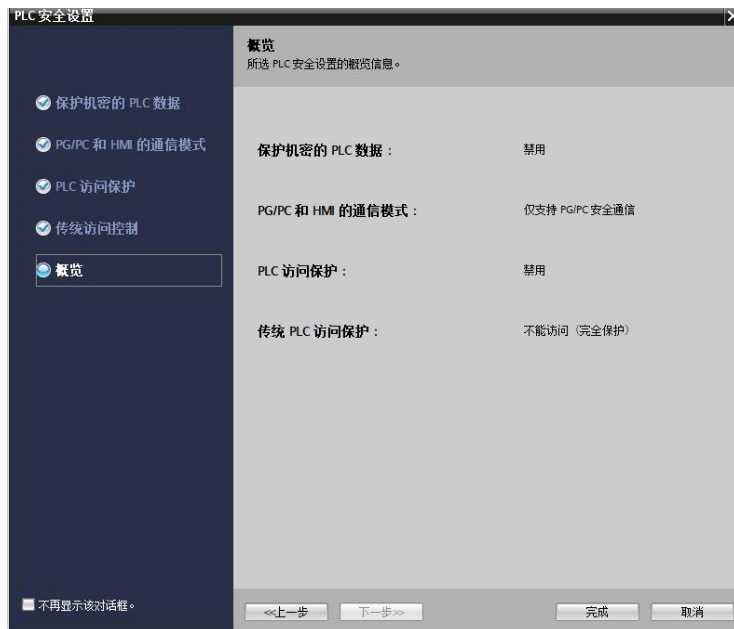
图 5 修改 PLC 安全概览
