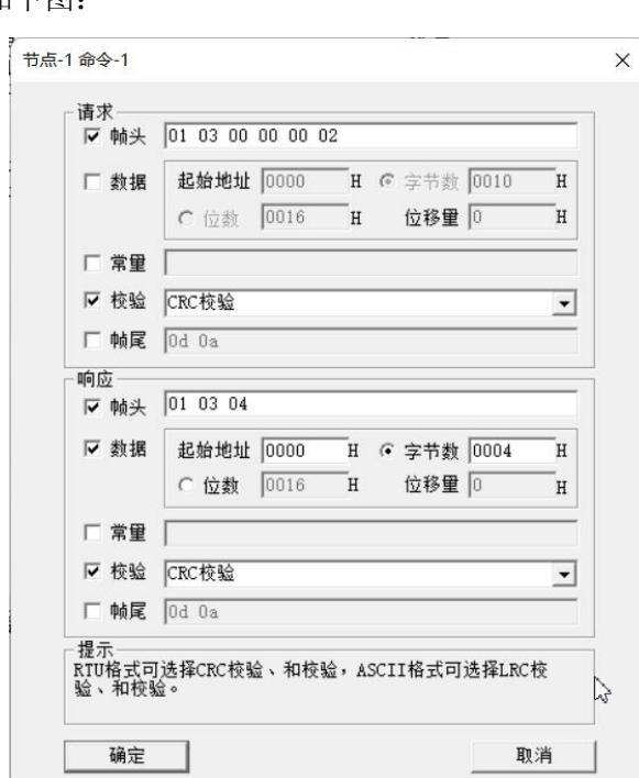
注: 在 RTU 传输格式下, 校验支持: 无校验、CRC 校验、和校验
