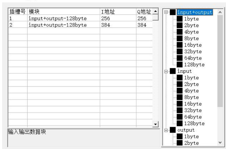
可以看到，上述一共配置了 2 个槽位，分别：128 字节输入/输出、128 字节输入/输出。
