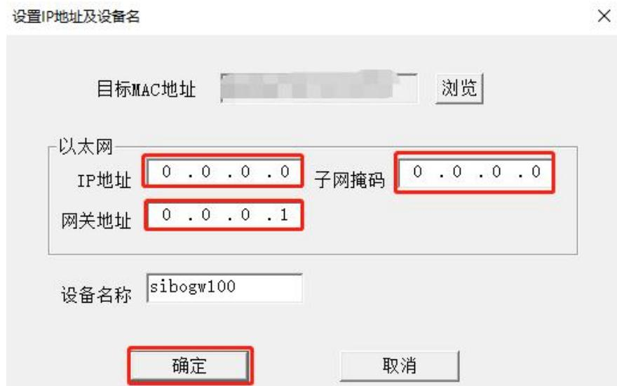
将“IP 地址”，子网掩码，网关地址分别设置为“192.168.0.18”，“255.255.255.0”，“192.168.0.1”，设置后，如下图示：
