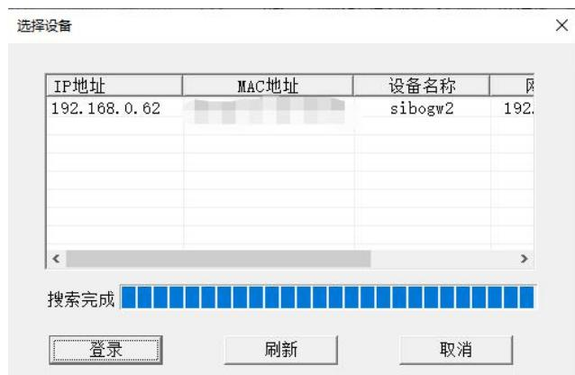
可以看到有 1 个 TS-181 设备在局域网上，显示设备的“IP 地址”、“MAC 地址”、“设备名称”、“网关地址”及“子网掩码”。
