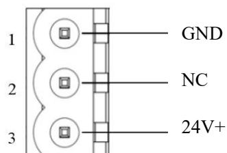
备注：直流电源为网关供电时，只连接端子 1 和 3。
