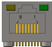
以太网口采用标准 RJ-45 接口，遵循 IEEE802.3u 100BASE-T 标准，10/100M 自适应，其引脚定义如下：
